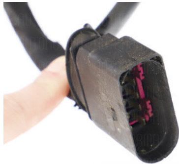
Elektrický konektor bez poškození
