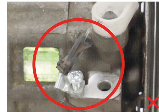
Poškozený / chybějící konektor
